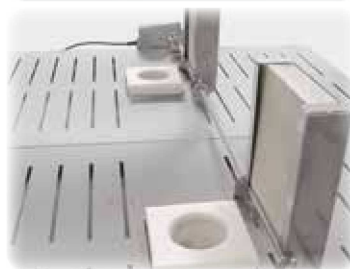
Afvoerluchtkep motorisch geregeld voor een snellere afkoeling van de oven na een voltooide brand.
