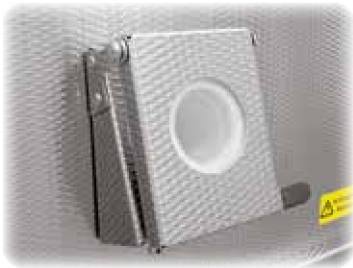
Kijkglas in de toevoerluchoopeningen voor de observatie van het glas.
